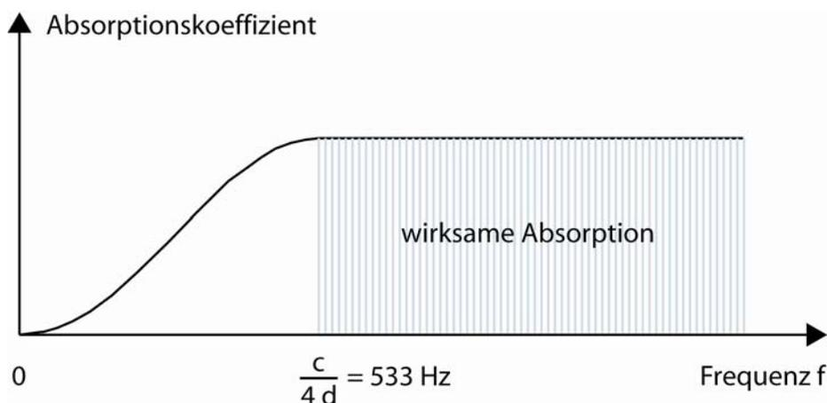
Für die 16 cm dicke Mineralfaserplatte gilt  $\frac{c}{4d} = \frac{341 \text{ m/s}}{4 \cdot 0.16 \text{ m}} = 533 \text{ Hz}$ .
