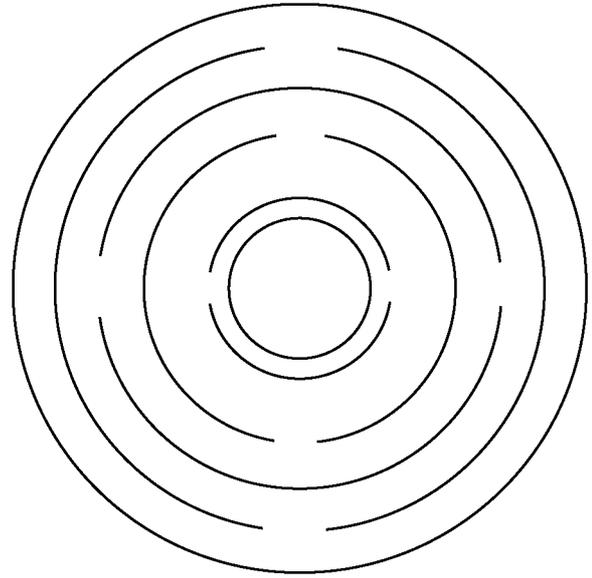
Durch einschnitte in einen Kreis entstehen Ringe, welche wie Lamellen eine Blendung verhindern, schöne Schatten werfen und dem Licht evtl. Farbe, und vor allem Stimmung verleihen. Durch d Parameter werden Länge, Grösse oder Wiederholung bestimmt, bzw. verändert.
