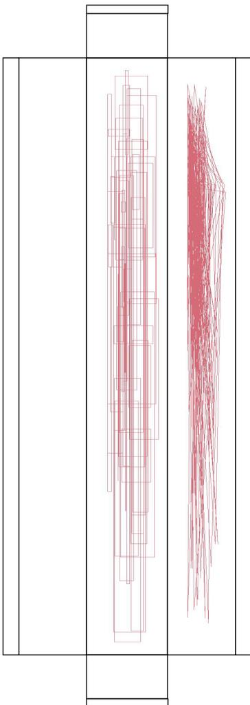
eine neonröhre wird von beschichtetem plexiglas umhüllt. licht scheint nur durch die eingelaserten muster hindurch. die dichte des musters kann durch parameter eingestellt werden, dadurch verändert sich die lichtmenge die abgestrahlt wird. als zusätzliche verstellmöglichkeit käme anzahl der ecken der umhüllfigur in frage. befestigt wird die umhüllung durch laschen die unter die lampenfassung geschoben werden.
