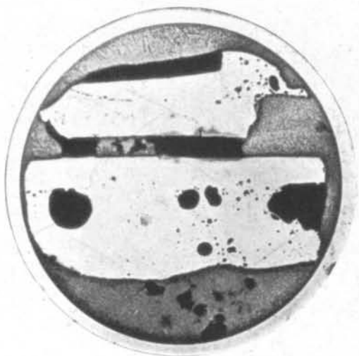
abb. 16 metallstrukturen 2 kupferstücke zusammengesweißt ( 2\frac{1}{2} mal vergrößert)
