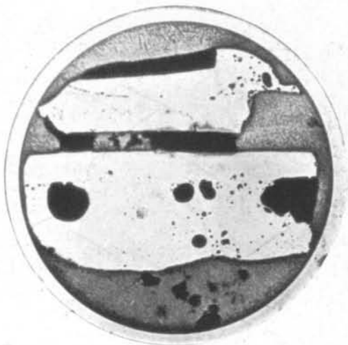
foto: kaiser-wilhelm-institut (metallografie) abb. 16 metallstrukturen 2 kupferstücke zusammengeschweißt ( 2\frac{1}{2} mal vergrößert)
