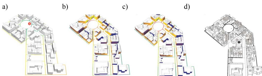
Abb. 17: a) Erreichbarkeit zu Fuss innerhalb von 15 Minuten, b) Sichtbarkeit - was man während 15 Minuten zu Fuss sieht und die am meisten sichtbaren Gebäude (von allen analysierten Ausgangspunkten) und Strassensegmente, welche die meisten Gebäude "zeigen", c) Am meisten sichtbare Fassadenoberflächen und Strassensegmente, mit den am meisten gesehenen Oberflächen, d) Gebäude mit Nr. 56 wird analysiert; Grau – Strassensegmente, die das Gebäude „sehen“, Schwarz – können das Gebäude nicht "sehen“.
